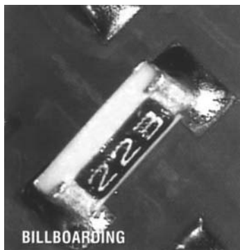
Дефект "рекламный щит"
