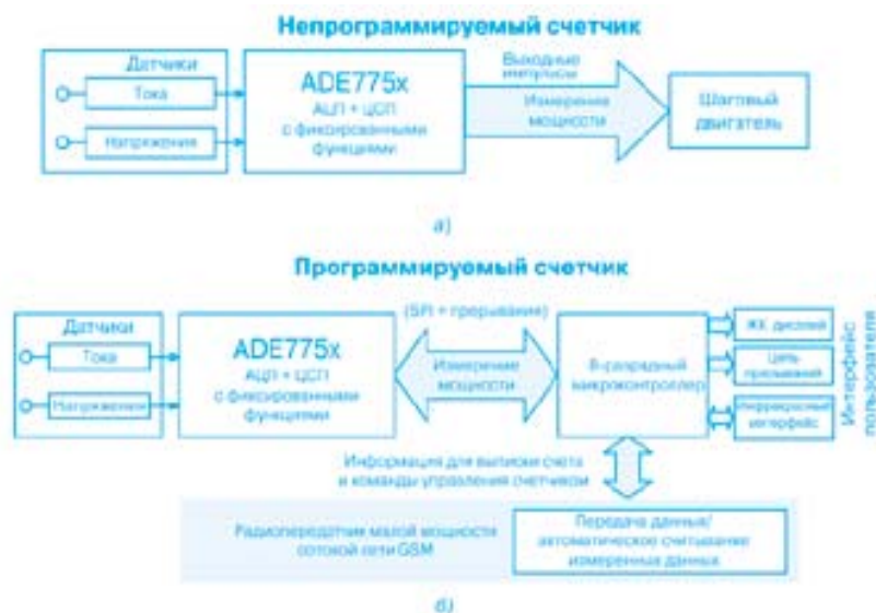
Рис. 1. Упрощенные структурные схемы непрограммируемого (а) и программируемого (б) счетчиков электроэнергии
